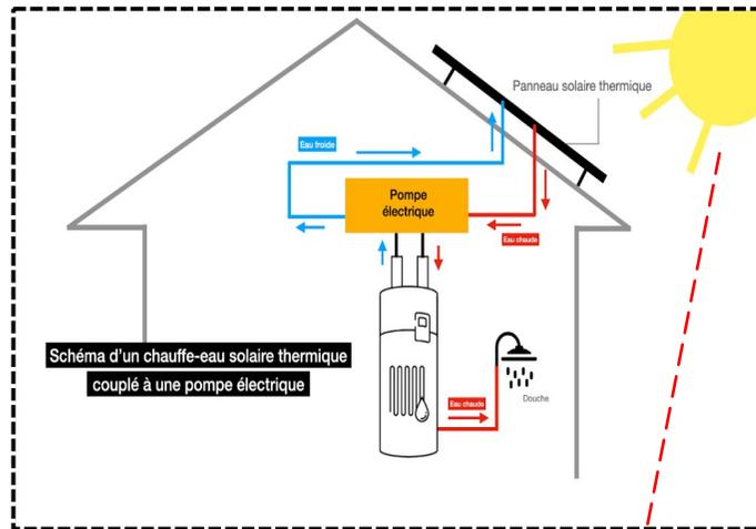
le panneau solaire capte l'énergie du soleil et la transmet soit directement à l'eau soit à un **fluide caloporteur**.
